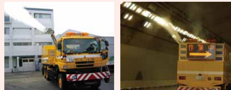
トンネル灯具清掃車(60km/h)で清掃が出来ます
